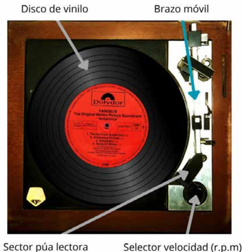
Tecnología analógica: Bandeja giradiscos para reproducir música con discos de vinilos que se utilizó en la etapa inicial de Radio Universidad Nacional de San Luis (1991)
