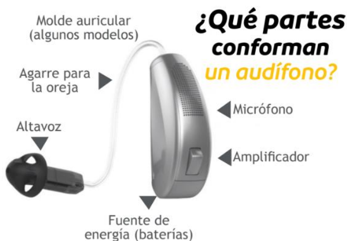
Ilustración 38. Partes que conforman un audífono 101 .
